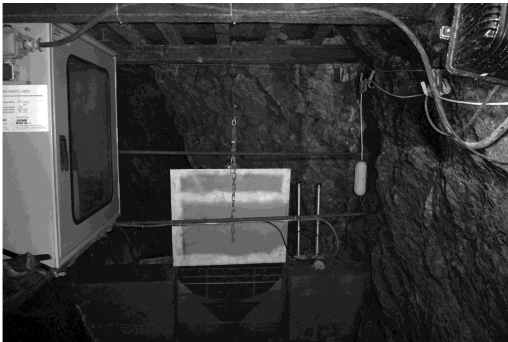
Abbildung 6 - Messwehr am Gesenk 2. Sohle
